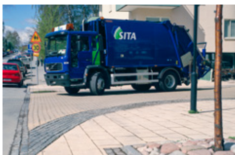
Fordonstyp 3: Tvåaxlig lastbil med tvillingmonterade däck.
